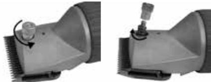
Legen Sie das neue Obermesser mit seinen vorhandenen Langlöchern auf die ovalen Zapfen des Scherkopfes. Das Untermesser wird nun auf die Bolzen gelegt. Schieben Sie die Flachrundschaube in das Vierkantloch des Untermessers. Drehen Sie die Maschine wieder in die seitliche Lage, stecken Sie die Feder auf die Flachrundschaube und schrauben Sie die Einstellschraube auf. Ziehen Sie die Einstellschraube soweit an, bis Sie einen leichten Widerstand verspüren.
